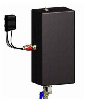
**Lieferumfang:** Einheit mit automatischer, steckerfertiger Drehzahlregelung der Umwälzpumpe; Referenzgröße für Regelung: Fühler im Pufferrücklauf mit Festwert zur Optimierung der Pufferrücklauf-temperatur.
